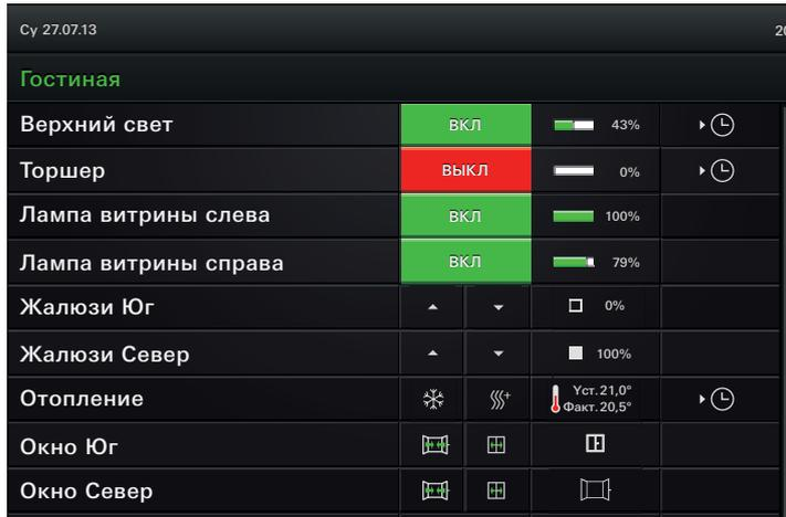
Достаточно одного взгляда, чтобы узнать о параметрах микроклимата в помещении. Все параметры можно отрегулировать непосредственно с помощью выведенного на экран диалогового окна. Это позволяет, например, одним касанием пальца включать и выключать освещение или поднимать и опускать жалюзи.
