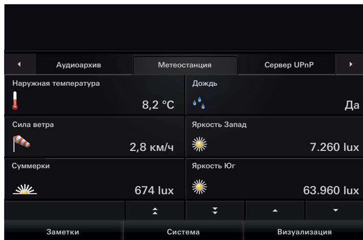
На экран можно вывести данные, полученные от погодной станции. Погодная станция измеряет скорость ветра, температуру и уровень освещенности, определяет возможность осадков и наступление сумерек.
