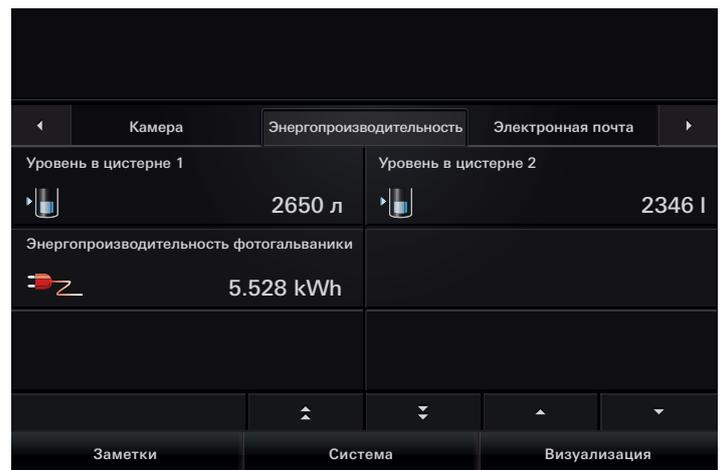
С помощью интерфейса Gira можно отобразить объем воды в резервуаре или емкость батареи фотогальванической установки.
