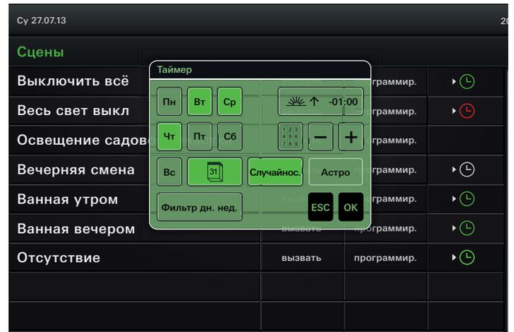
Для каждого помещения можно определить профиль использования с указанием времени, в которое требуется осуществлять обогрев или вентиляцию. Таким образом, исключается бесполезная работа систем отопления и вентиляции.
