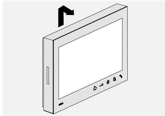
Для демонтажа придерживать квартирную станцию сбоку и сильно сдвинуть большим пальцем вверх, пока она не высвободится из фиксатора.
