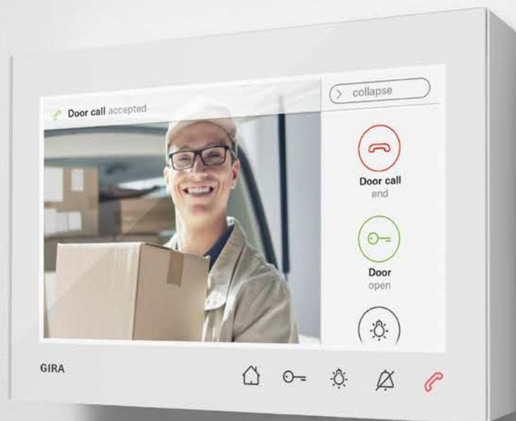
Управление осуществляется с полноэкранным сенсорным дисплеем. Кроме того, с помощью пяти кнопок быстрого набора, расположенных в нижней части экрана, можно управлять основными функциями, такими как принятие звонка, включение света или отключение звука звонка.
